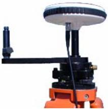
Vorbereiten der kinematischen Initialisierung an der Basis mit dem Initialisierungsstab
