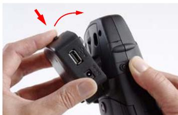
6. Stecken Sie den Netzstecker ein (siehe unten) und laden Sie die Batterien etwa sechs Stunden lang auf.
